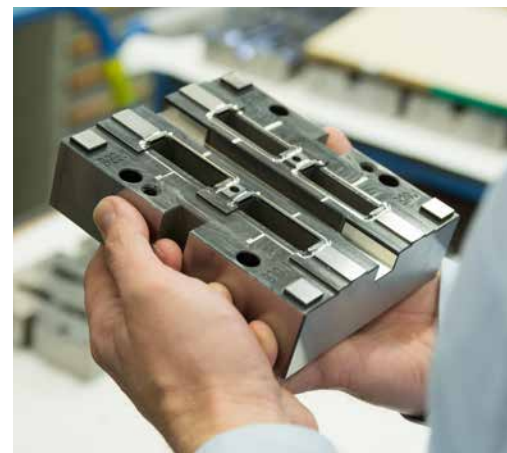
Компетенция для мульти-инструмента: многокомпонентные пресс-формы для производства повседневных продуктов.
