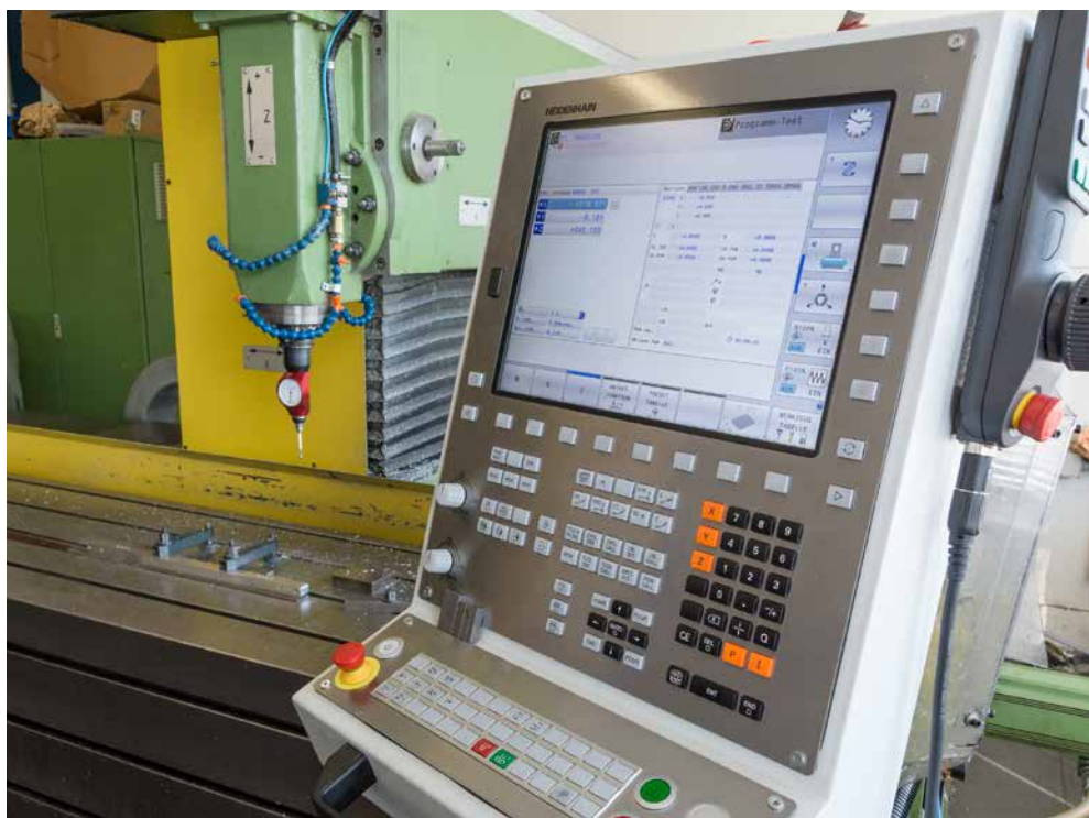
Работа с TNC 320 на цветном TFT-экране, размером 15 дюймов очень удобна.
