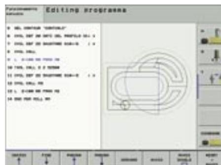
Figura 1: percorsi di spostamento per sgrossatura
