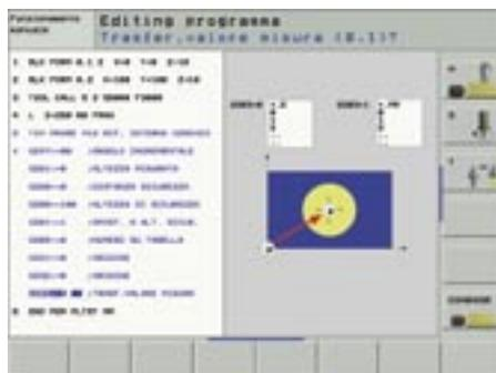
Figura 3: ciclo di tastatura con trasferimento del valore alla tabella Preset
