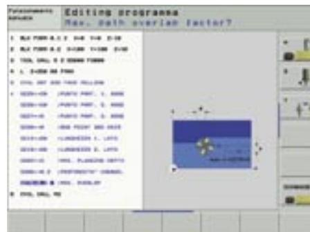
Per poter ottimizzare i tempi di lavorazione, è stato eliminato il ritorno al punto di partenza indicato. Alla fine dell'ultima traiettoria di fresatura il TNC avanza immediatamente alla profondità successiva e lavora partendo da questa posizione in direzione del punto di partenza impostato.
