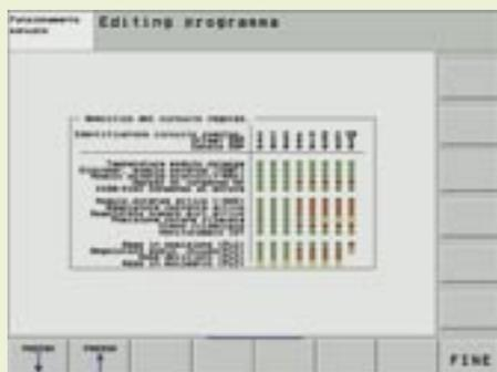
*Rappresentazione delle informazioni rilevanti per la regolazione mediante „LED di stato“ con il TNCdiag sull'iTNC 530*
