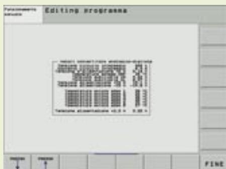
*Rappresentazione dei segnali analogici del sistema di azionamento con il TNCdiag sull'iTNC 530*
