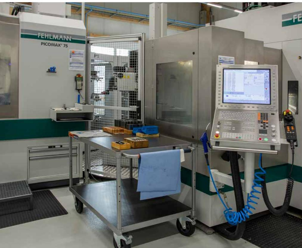
Configurazione standard: due macchine con un sistema a pallet consentono turni senza presidio durante la notte e nel fine settimana.
