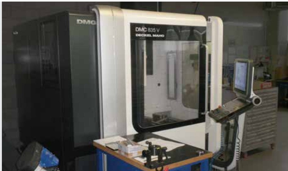
Centro di lavoro 4 assi DMG DMC 835V equipaggiato di controllo numerico HEIDENHAIN iTNC 530 e tastatore elettronico TS 640
