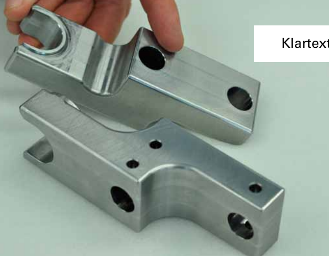
Ausilio di montaggio programmato direttamente sul controllo numerico
