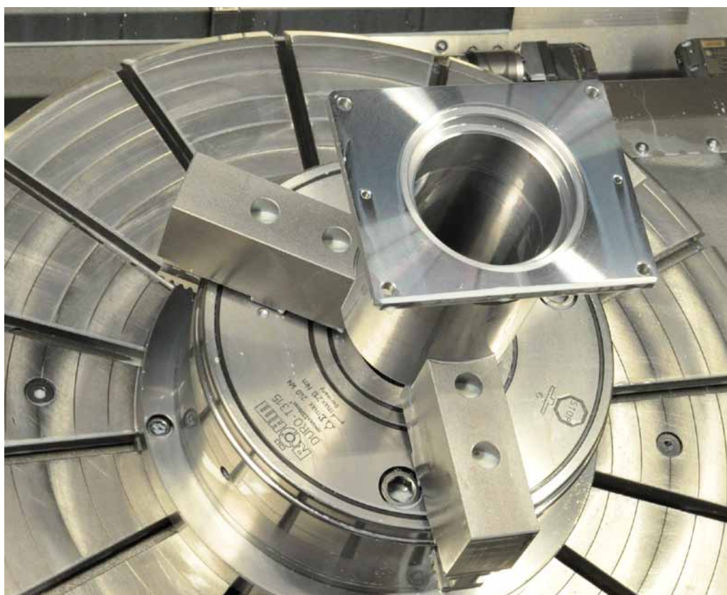
Il TNC 640 semplifica le funzioni complesse: le lavorazioni inclinate possono essere programmate direttamente sulla macchina
