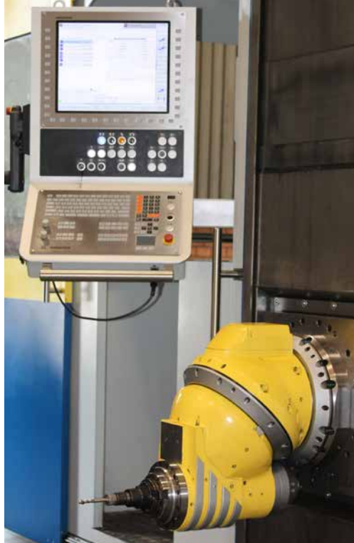
Sicma ha scelto i TNC 640, controlli numerici evoluti e flessibili con numerose funzioni orientate alla gestione digitale delle commesse.
