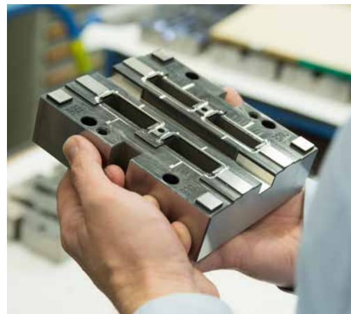
Competenza per cavità multiple: stampi per iniezione a più componenti per la produzione di prodotti d'uso quotidiano.
