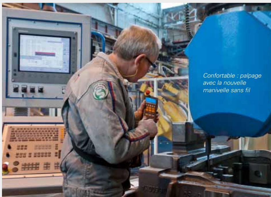
Confortable : palpage avec la nouvelle manivelle sans fil
