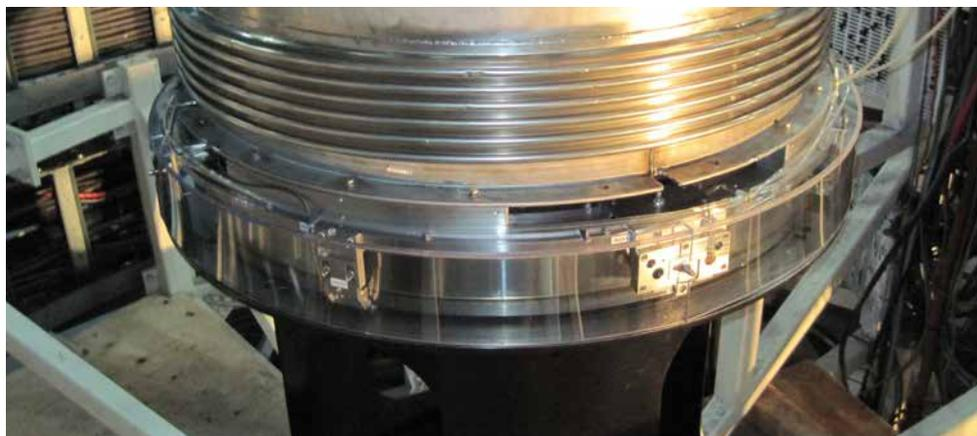
Montage des systèmes de mesure angulaire ERA 8400 sur le système d'entraînement des télescopes pour le positionnement azimut
