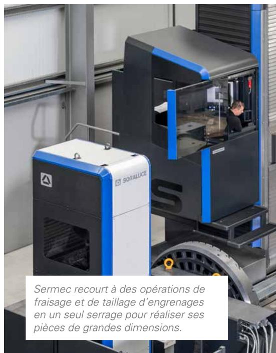
*Sermec recourt à des opérations de fraisage et de taillage d'engrenages en un seul serrage pour réaliser ses pièces de grandes dimensions.*
