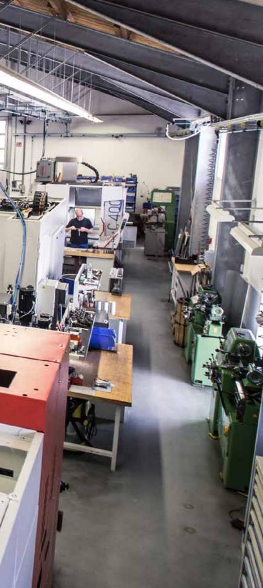
L'atelier de WB mechanics : six tours et six fraiseuses équipées de commandes HEIDENHAIN sont connectés à StateMonitor.
