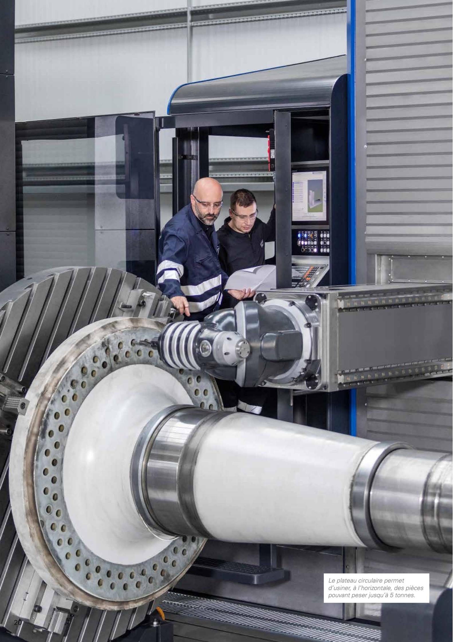
*Le plateau circulaire permet d'usiner, à l'horizontale, des pièces pouvant peser jusqu'à 5 tonnes.*
