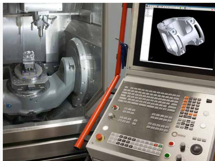
Les données 3D d'une pièce complexe, comme celle de ce support de guidon de VTT par exemple, peuvent être directement reprises dans le programme CN.
