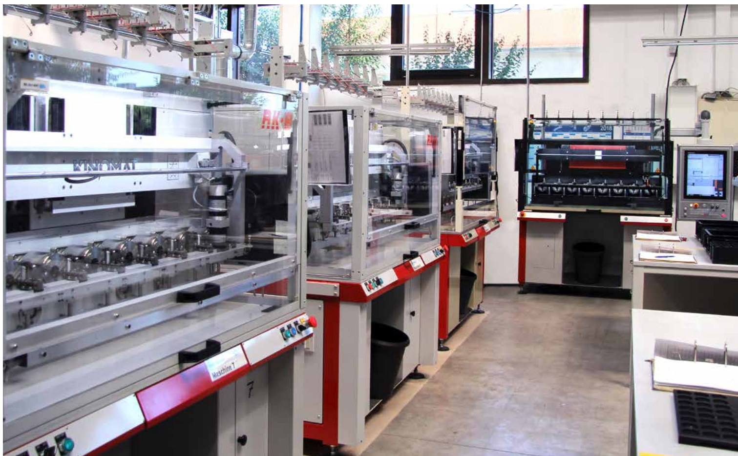
Tout au fond se trouve la machine de bobinage de résolveurs avec la commande TNC 620 et, à gauche, trois des six installations qu'il est prévu de rétrofiter d'ici la fin 2019.
