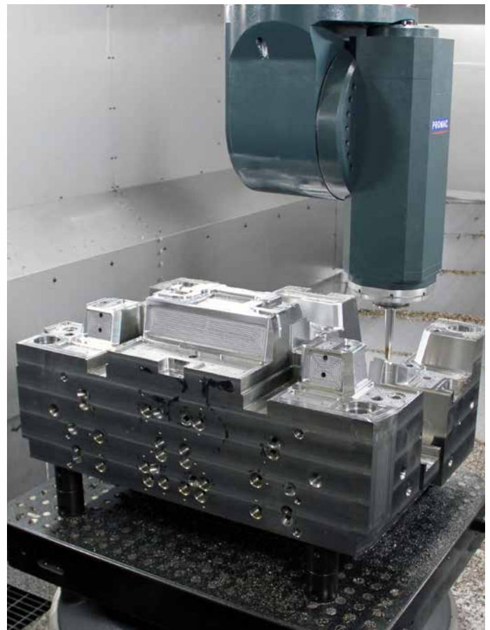
Adaptabilité : le système de changement de tête de machine permet de réaliser tous les types d'usinage sur une seule et même machine.
