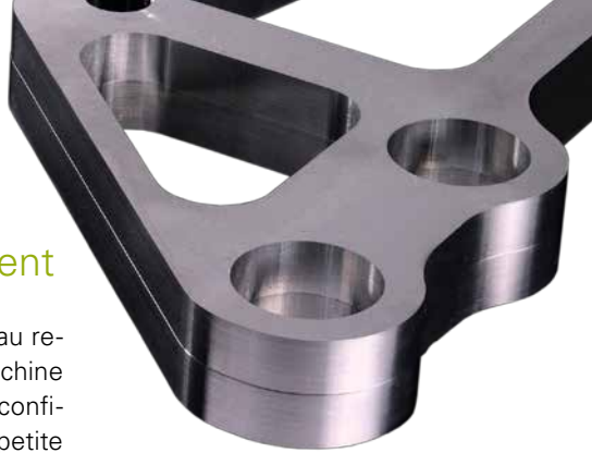
L'écart de 70 \mu m, conséquence de l'échauffement de la vis à billes, est clairement visible avec le double usinage
