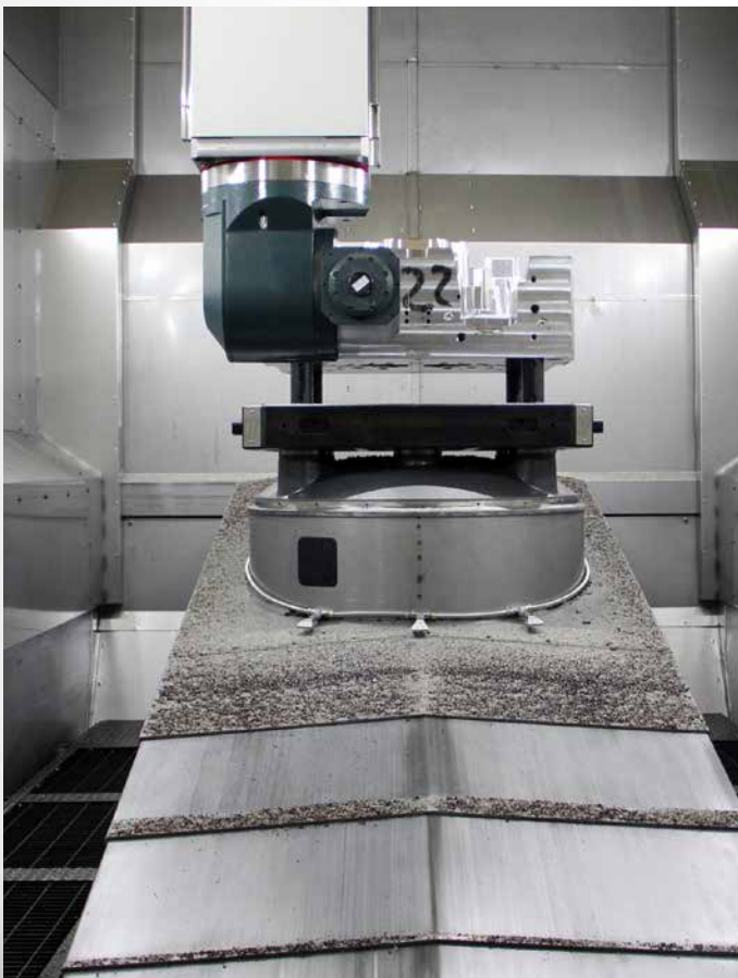
Flexibilité : la table inclinée permet de percer et de fraiser avec cinq axes, sur cinq surfaces.
