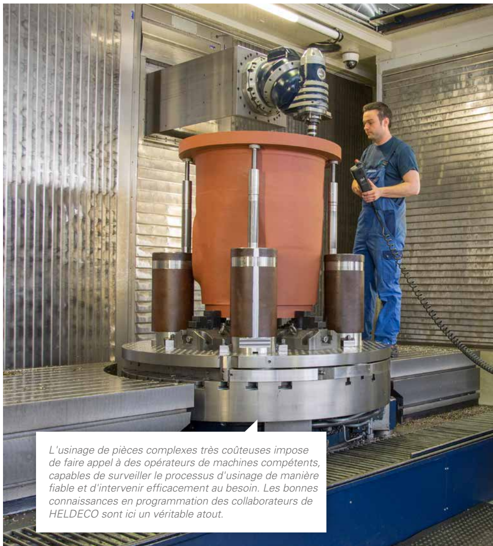
Qu'il s'agisse d'une opération de fraisage ou de tournage, la commande HEIDENHAIN facilite l'intervention de l'opérateur par une représentation claire et explicite de la situation.
