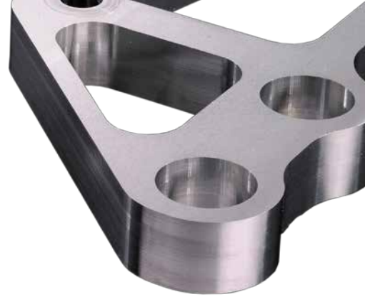
Deuxième procédure de perçage en Closed Loop : La pièce ré-usinée ne fait apparaître ni bordure, ni recoin disgracieux.
