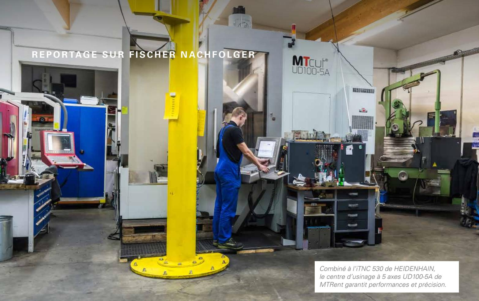
Combiné à l'iTNC 530 de HEIDENHAIN, le centre d'usinage à 5 axes UD100-5A de MTRent garantit performances et précision.
