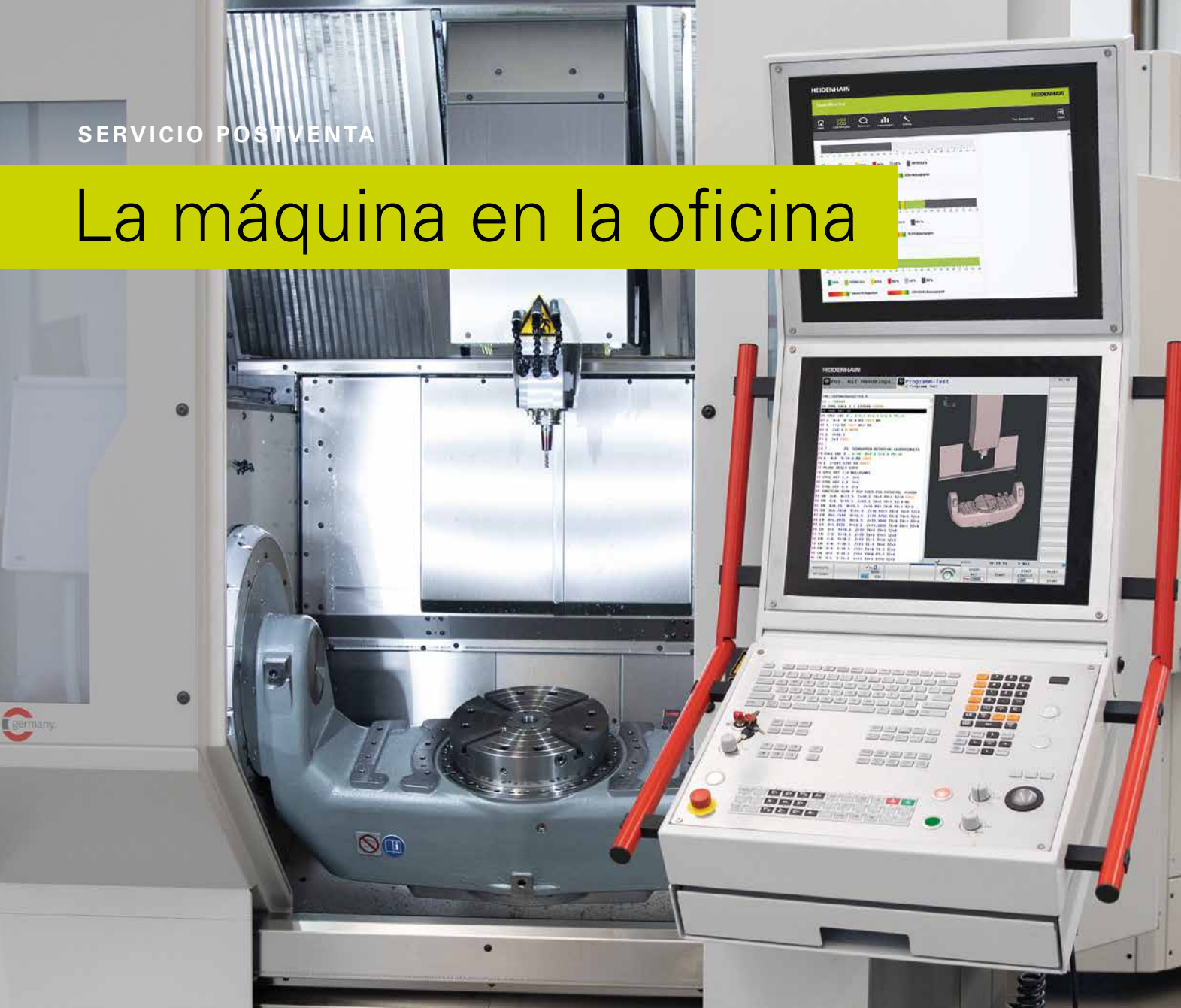
El original en el taller: un centro de mecanizado de 5 ejes con TNC 640.
