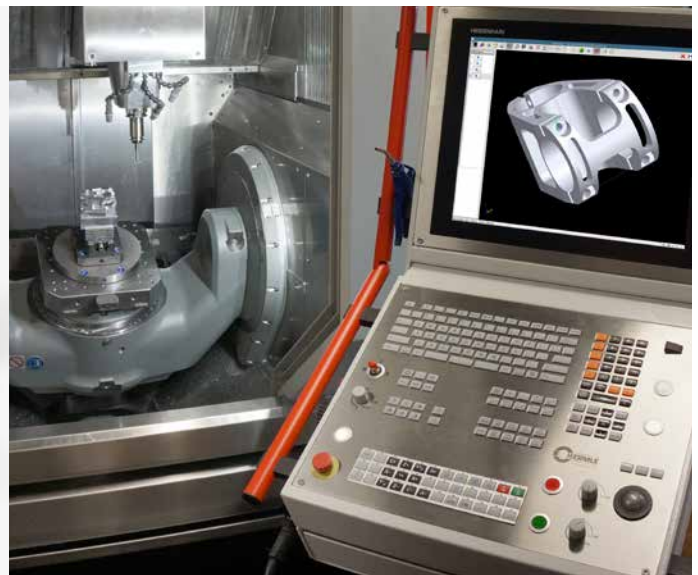
Los datos tridimensionales de un componente complejo, por ejemplo, este soporte para manillar de una bicicleta de montaña, se pueden transferir directamente al programa NC.
