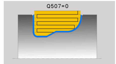
El ciclo de profundización por torneado reduce el tiempo de mecanizado.
