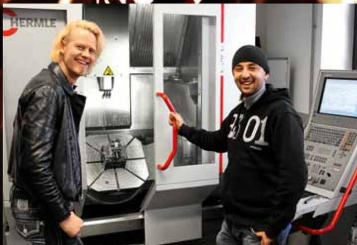
Usinage 5 axes, le bon choix pour l'usinage de composants pour accordeurs de guitare. Ici l'iTNC 530 garantit la plus grande précision.
