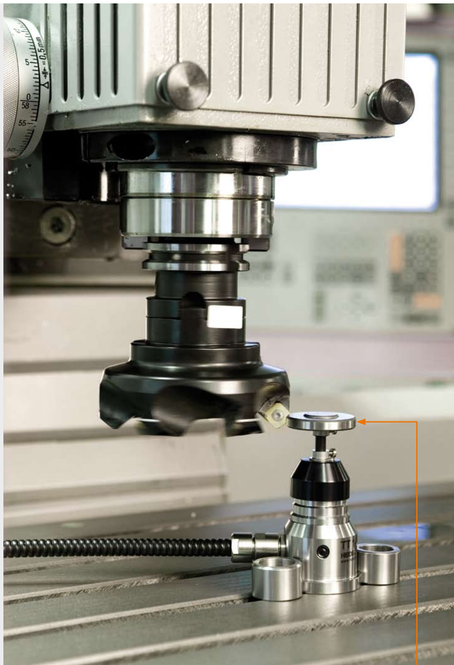
Verschleißfreie und zuverlässige Werkzeugvermessung mittels scheibenförmigem Antastelement des TT 140
