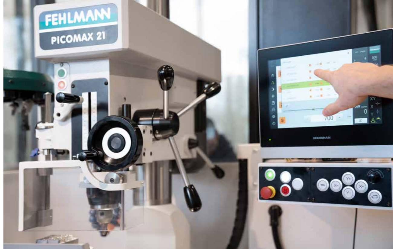
Handbediente Maschine mit Motortisch und POSITIP 8000 ACTIVE: So ersetzt die FEHLMANN PICOMAX 21-M einfache CNC-Maschinen.
