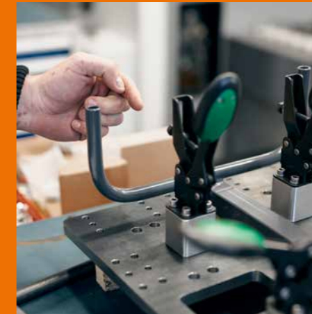
Der Probeaufbau der Schweißschablone mit Schubspannern und eingelegter Befestigung.
