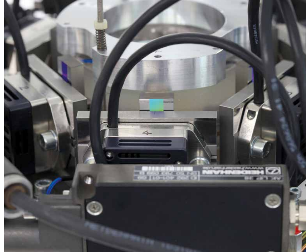
Umlagerter Filter: Rund um die beiden Glasplatten sitzen die sechs HEIDENHAIN-Längenmessgeräte.
