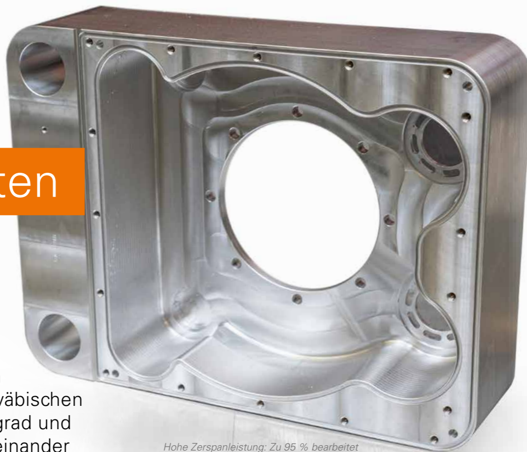
Hohe Zerspanleistung: Zu 95 % bearbeitet Schubert Fertigungstechnik Aluminium, meistens wird aus dem Vollen zerspannt.
