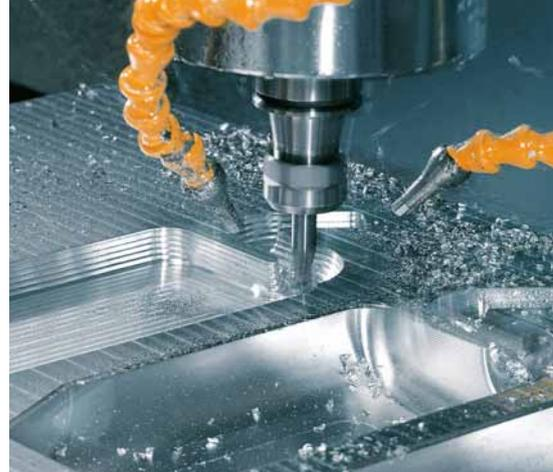
*Dynamisch und effizient: Für mehr Spanvolumen bei der Schruppbearbeitung.*
