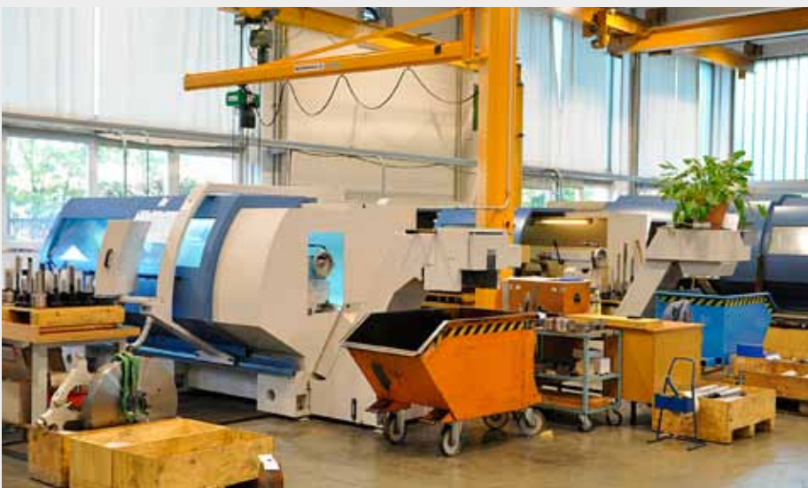
Alle DMT-Drehmaschinen sind mit HEIDENHAIN-Drehmaschinen-Steuerungen ausgestattet.
