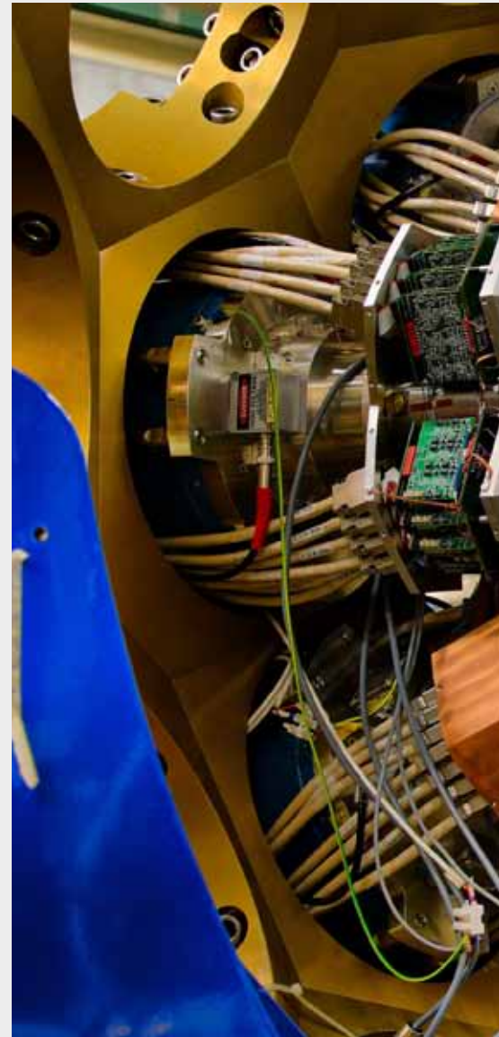
Der AGATA-Prototyp aus Legnaro mit 15 Germanium-Detektoren.
