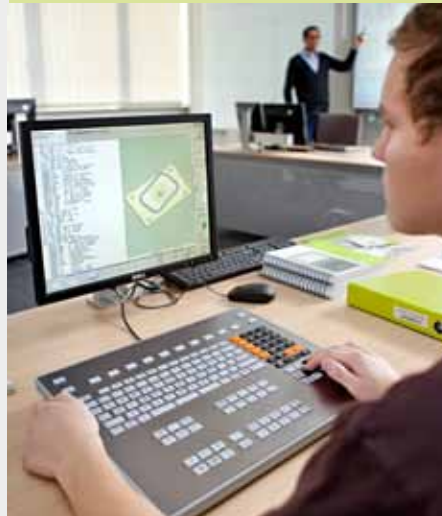
Angehende Feinwerktechniker erlernen direkt an einem original HEIDENHAIN-Programmierplatz die Klartext-Programmierung.
