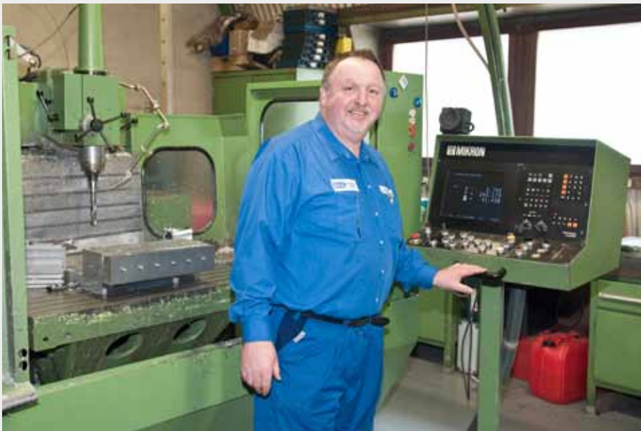
Karl Kubina an seiner „alten Mikron“ mit der HEIDENHAIN TNC 155 Steuerung – seit 31 Jahren im Einsatz.
