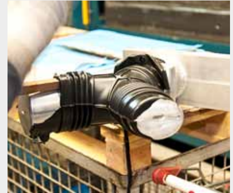
Das fertig gegossene Gummiformteil wird gerade aus der Form genommen.
