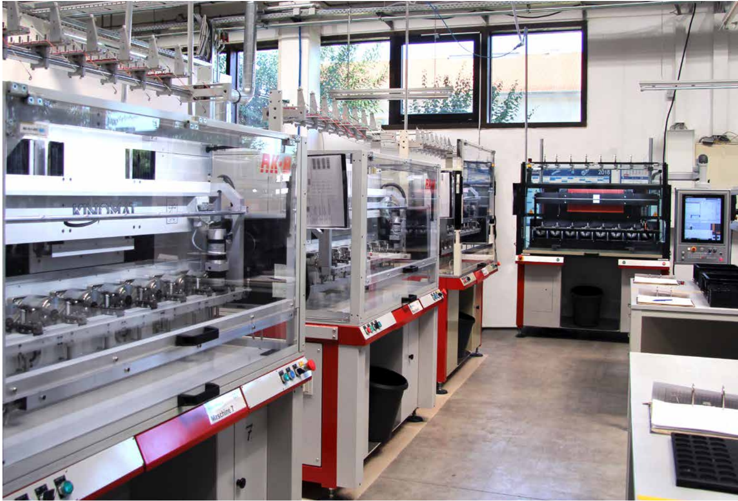
Am Kopfende steht die umgerüstete Resolverwickelmaschine mit der TNC 620-Steuerung, links drei der sechs Anlagen, die bis Ende 2019 noch umgerüstet werden sollen.
