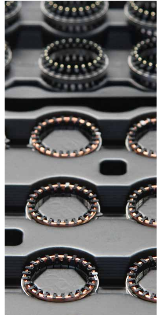
Vorher – nachher: vorne die fertigen, hinten die noch leeren Statorwickelkerne
