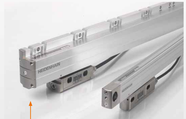
Kompensieren thermische Abweichungen: hochgenaue Längenmessgeräte für die Werkzeugmaschine in einer Closed Loop-Regelung
