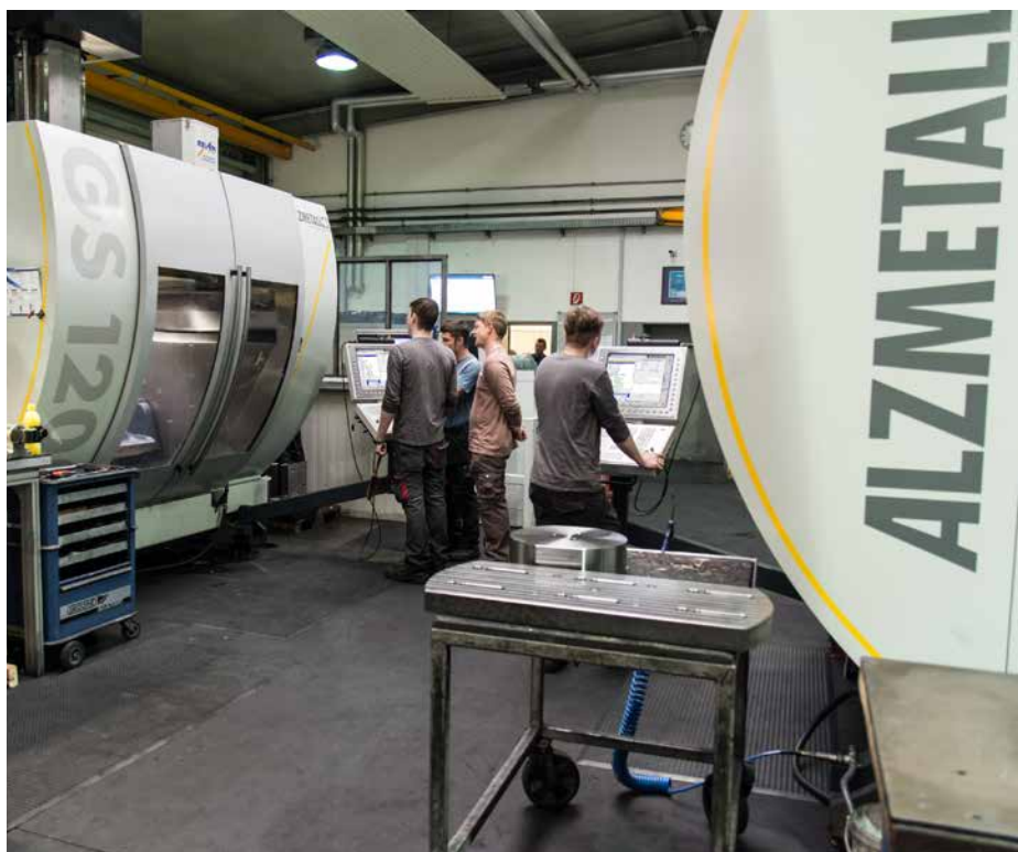
„Hier haben wir das Fräsen und Drehen vereint gesehen.“ Die zwei neuen Alzmetall Bearbeitungszentren GS 1200/5 FDT mit der HEIDENHAIN TNC 640
