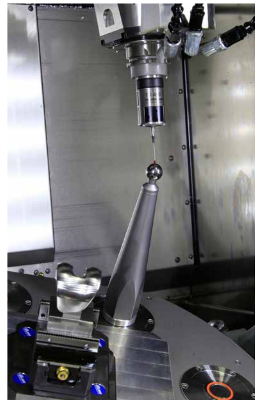
Genauer vermessen mit 3D-ToolComp und Antastzyklus 444
