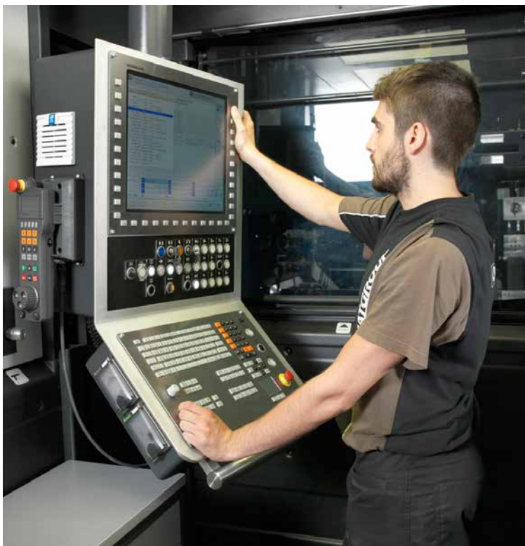
Manuelle Eingriffe während der Bearbeitung können die Maschinenbediener über die TNC-Steuerungen vornehmen.
