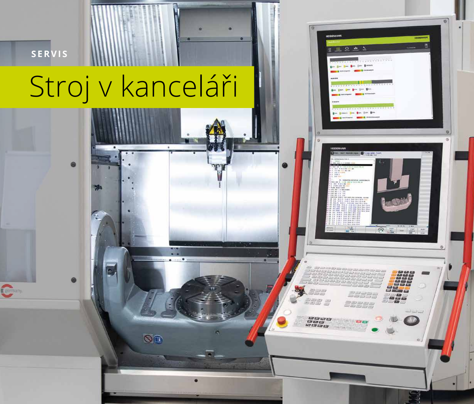
Originál v dílně: 5osé obráběcí centrum s řídicím systémem TNC 640.
