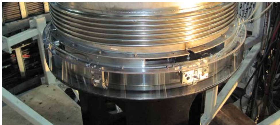
Montáž úhlových odměřovacích snímačů ERA 8400 na pohonu teleskopu pro azimutální polohování
