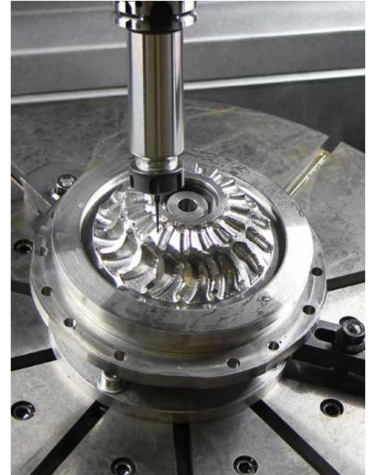
Pohled do obráběcího prostoru stroje – obrábění impelleru
