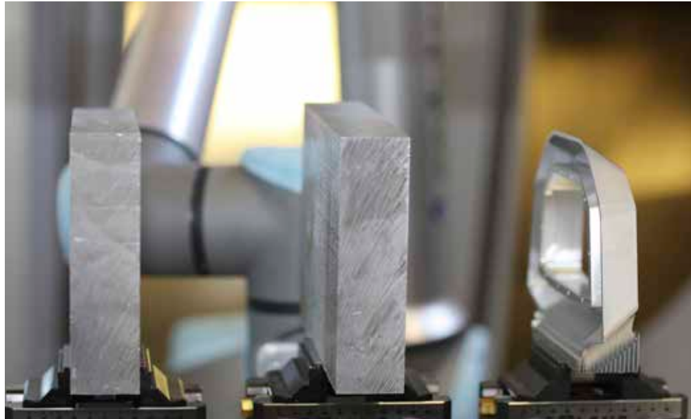
准备夜班生产：将工件毛坯安装在托盘交换系统上。
