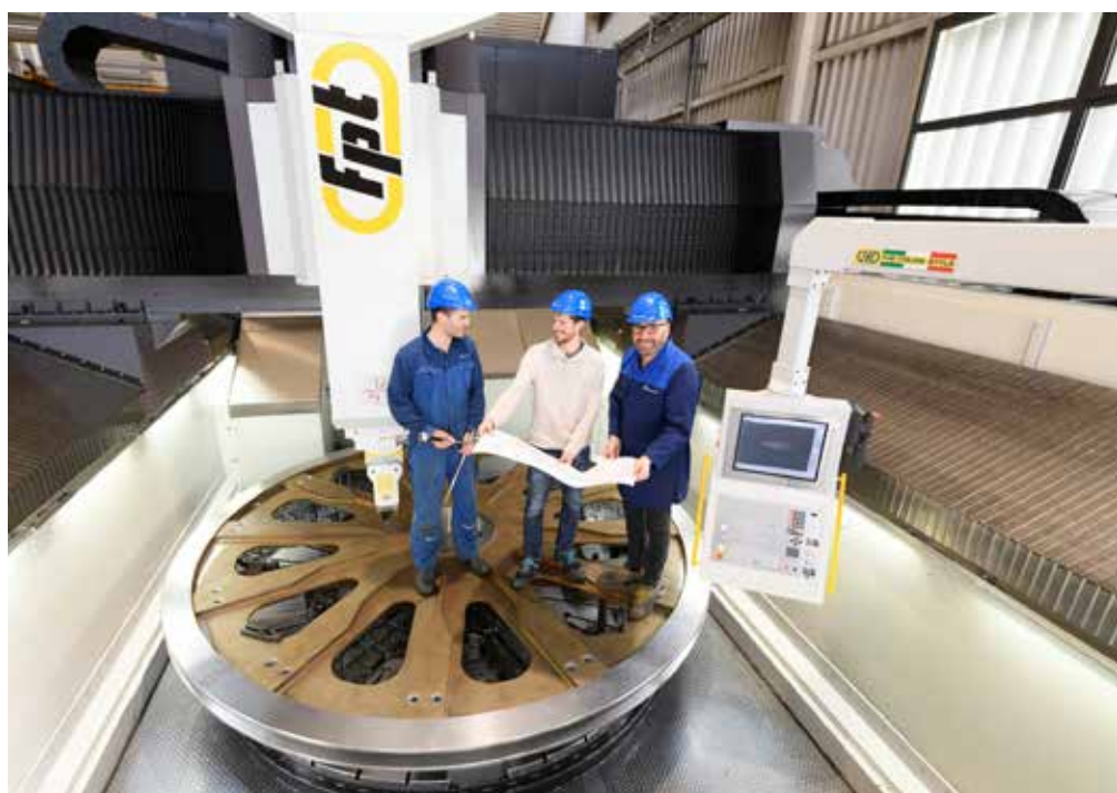
在这张照片中，Christof Karlegger（左），Ing. Peter Plattner（中）和Franz Frei（右）正在装夹为伦敦卢顿机场生产的大型钢索绞轮，从图中可见这台机床为大型工件提供的巨大加工区。
