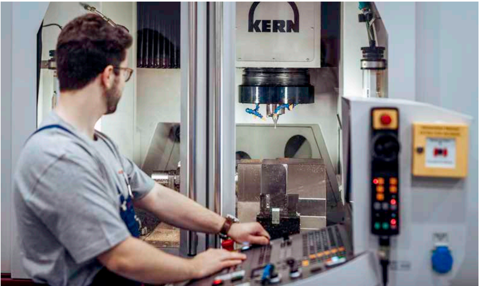
海德汉iTNC 530数控系统和Klartext对话式编程语言使NH Watches生产的工件精度达到高于实际要求的精度。
