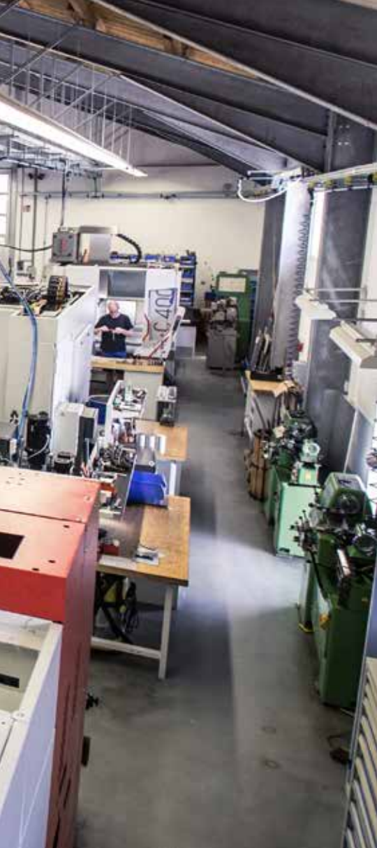
WB mechanics的生产车间：六台配海德汉数控系统的铣床，六台车床，全部连接“状态监控”软件。
