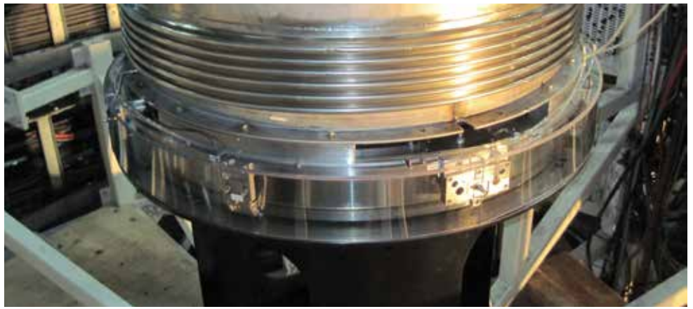
测量方位位置的ERA 8400角度编码器在望远镜驱动系统上的安装情况
