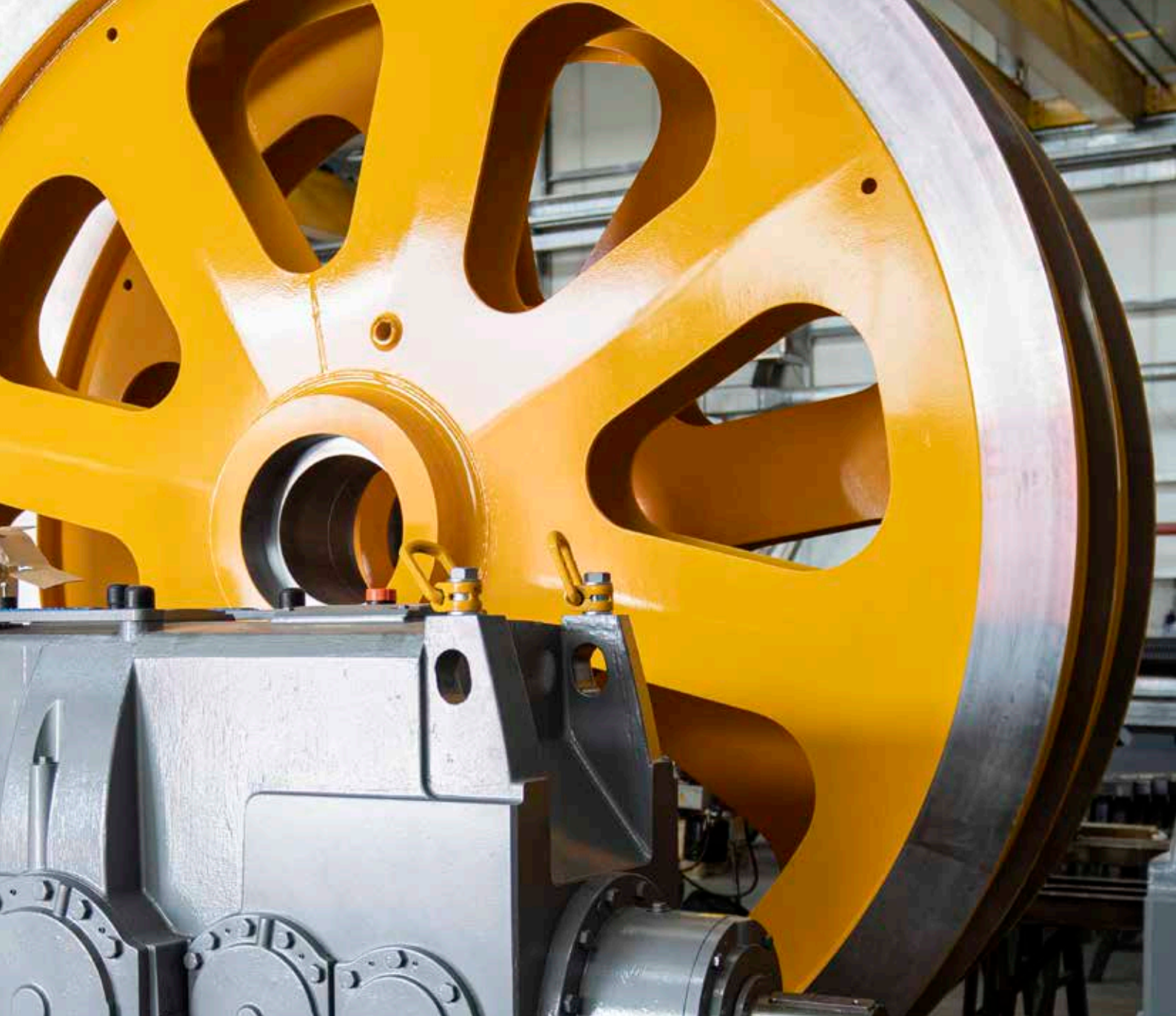
超大尺寸：伦敦卢顿机场钢索绞轮及其驱动系统，每个绞轮直径达3.6米。
