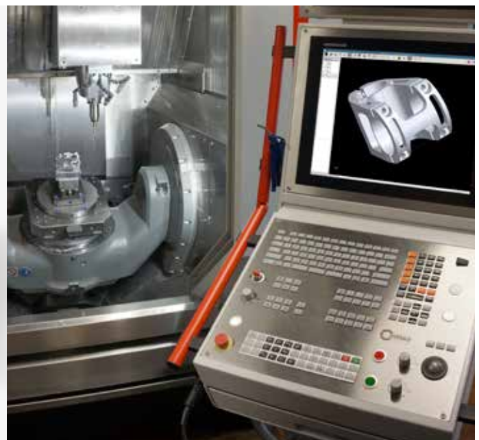
复杂工件的3D数据，例如山地自行车车把支架，其数据可直接导入到NC程序中。
