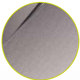
由机床专用的海德汉电机加工的平斜面无任何明显暗区。
