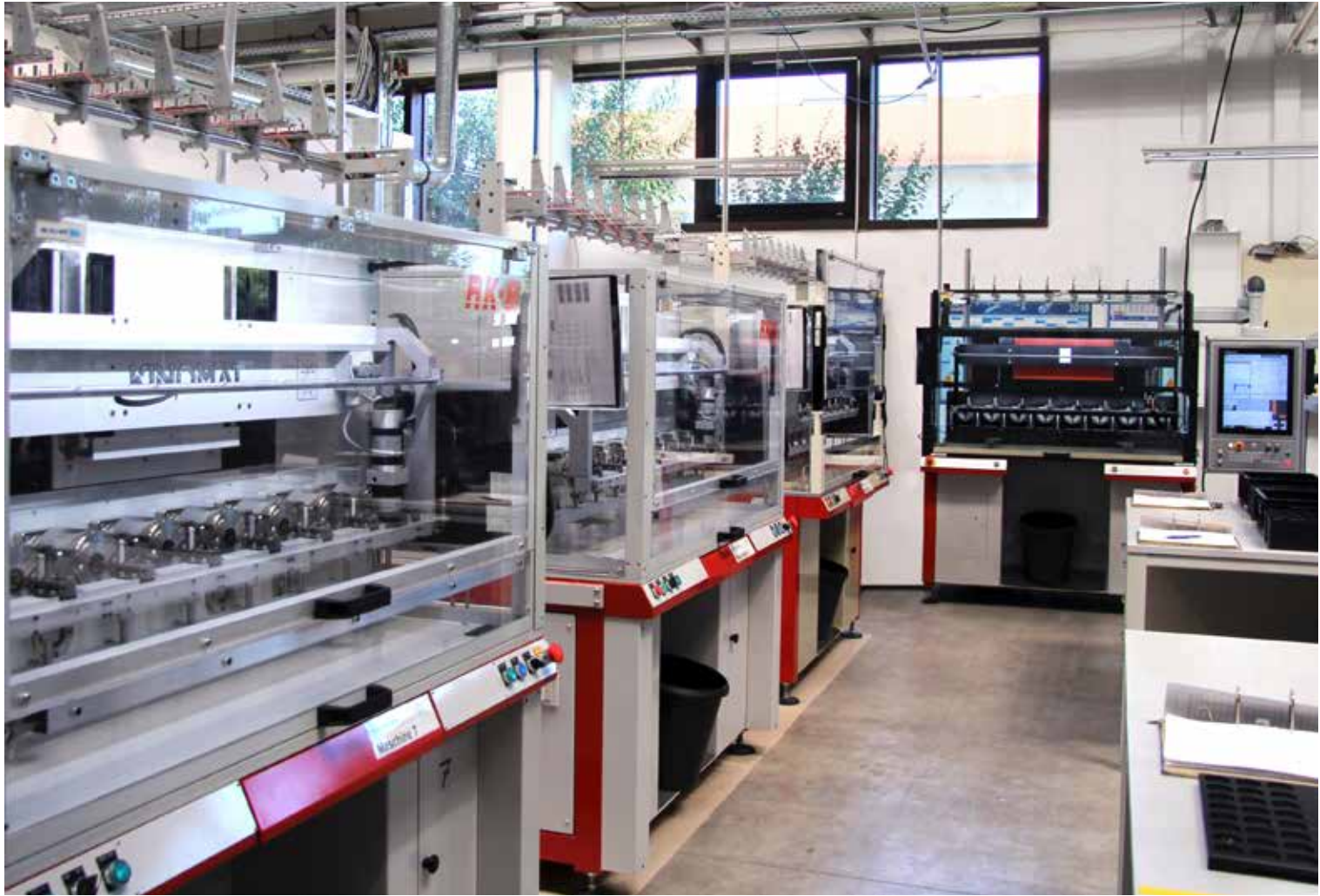
搭载TNC 620数控系统的升级版旋转变压器绕线机位于顶头位置。到2019年年底，将改造左侧六台绕线机中的三台。
