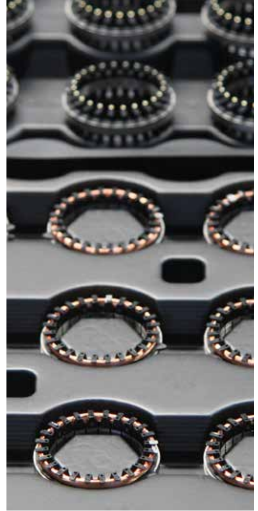
之前和之后：上方为绕线前的空定子绕组铁心，下图为绕线后的定子绕组铁心。
