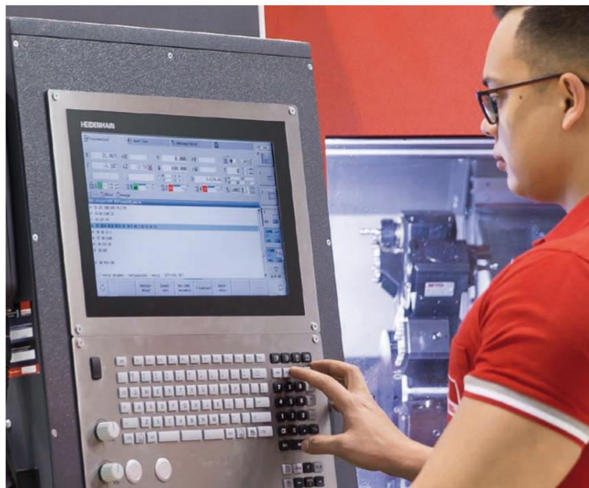
Independientemente de si se fabrican piezas torneadas simples o piezas complejas, con CNC PILOT 640 se saca provecho de la introducción de contornos gráfica y de la confortable programación con smart.Turn.
