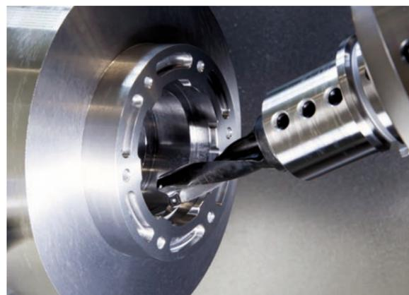
Mecanizado en el plano inclinado
