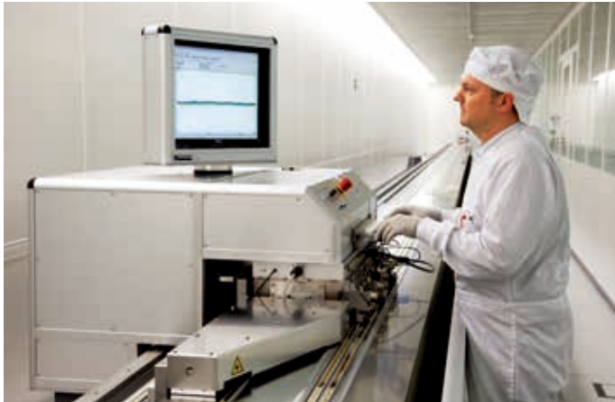
30 m长测量机应用的钢带光栅尺
