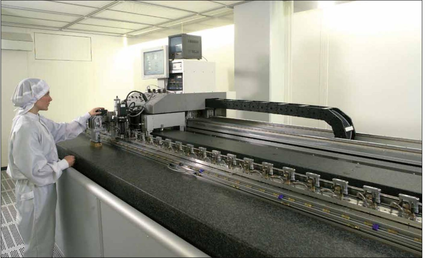
图9：对于每一只敞开放式直线光栅尺的光栅尺带，海德汉用特殊的测量机确定定义的间隔宽度上的基线误差。
