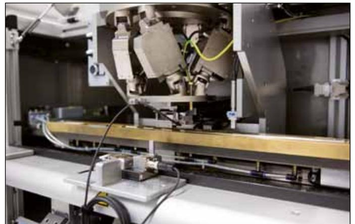
图10：每一只敞开放式直线光栅尺的细分偏差都在特殊测量机上用读数头进行测量。
