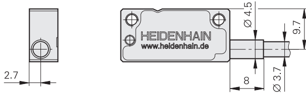
Kabelausgang rechts gewinkelt; 0°
