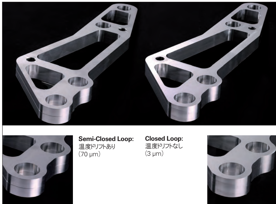
図5 結合レバー：同じ形状を2度加工した例
