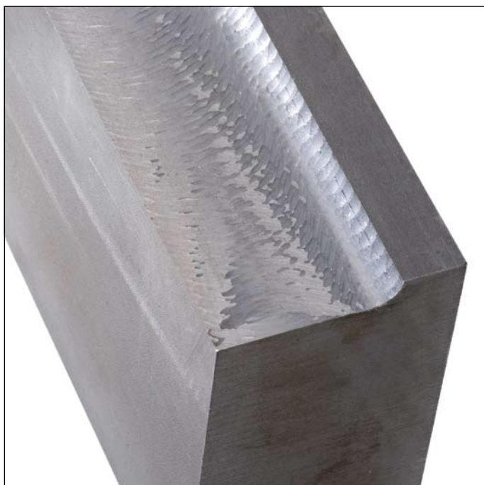
Pezzo fresato senza ACC: sono visibili evidenti rigature da vibrazioni.
