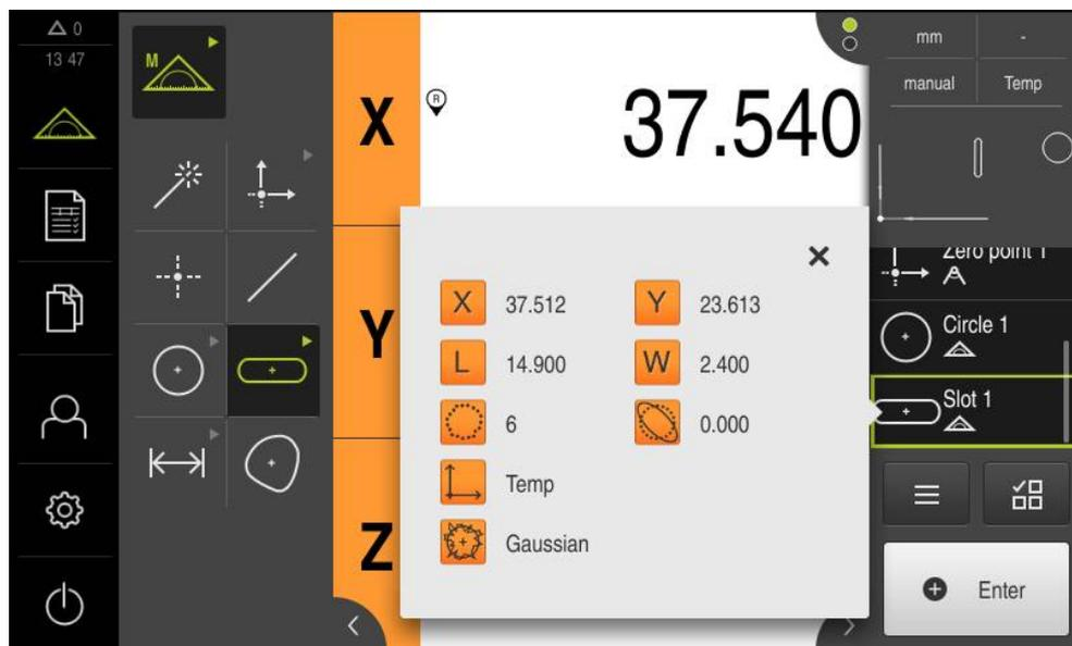
圖形 37: 部件清單內的溝槽部件，含量測結果預覽
