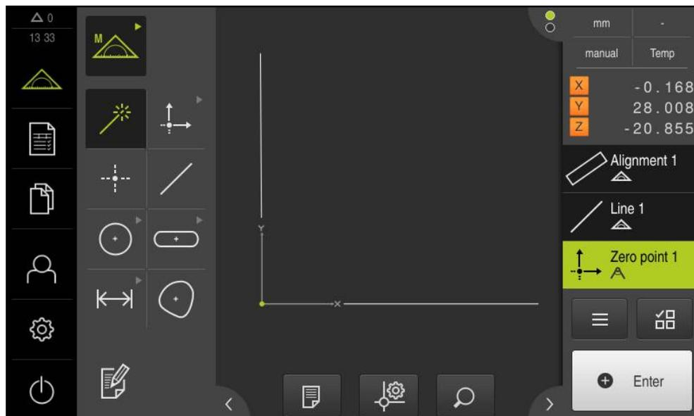
圖形 34: 具備座標系統內所顯示原點的工作空間
