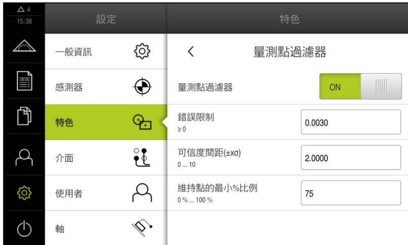
圖形 90: 量測點篩選的設定
