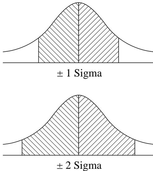
圖形 92: 可信度間距的圖解圖
