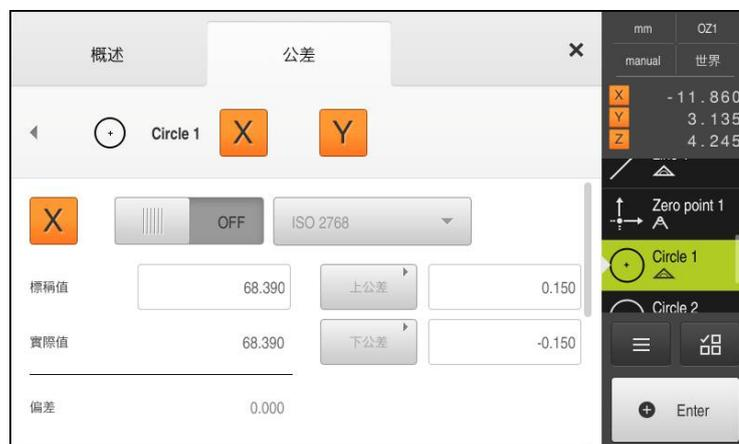
圖形 51: 尺寸公差含已啟動尺寸公差 X 的概述
