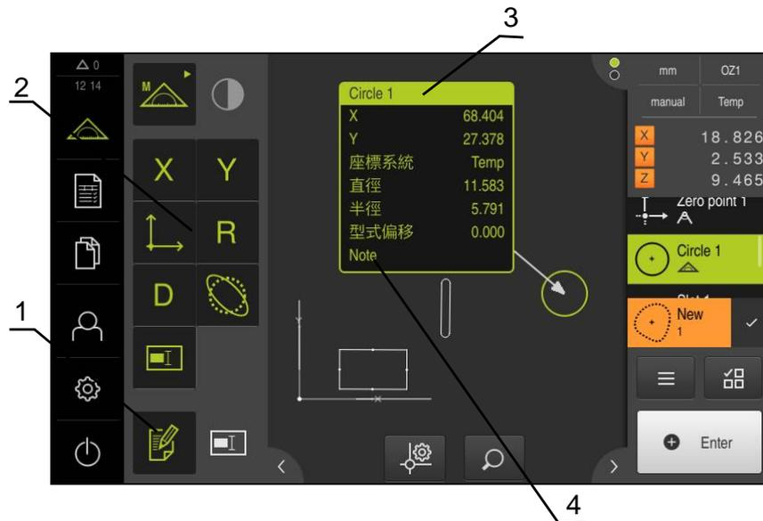
圖形 52: 注釋的操作元件以及含注釋的部件
