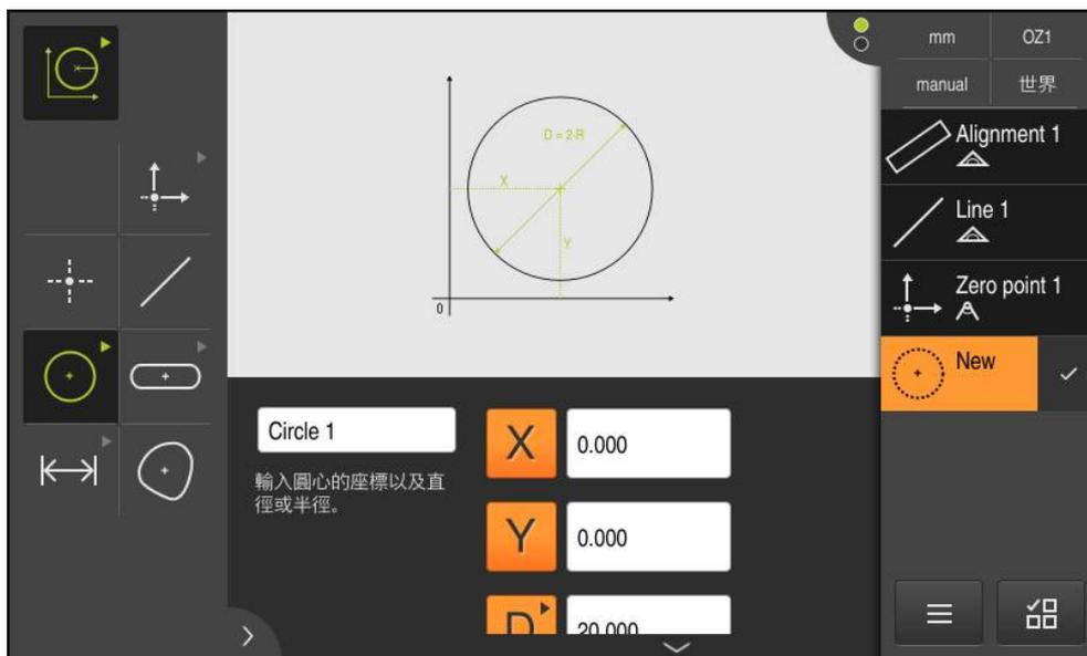
圖形 62: 工作空間的部件畫面中以及檢測器的部件清單中之定義部件
