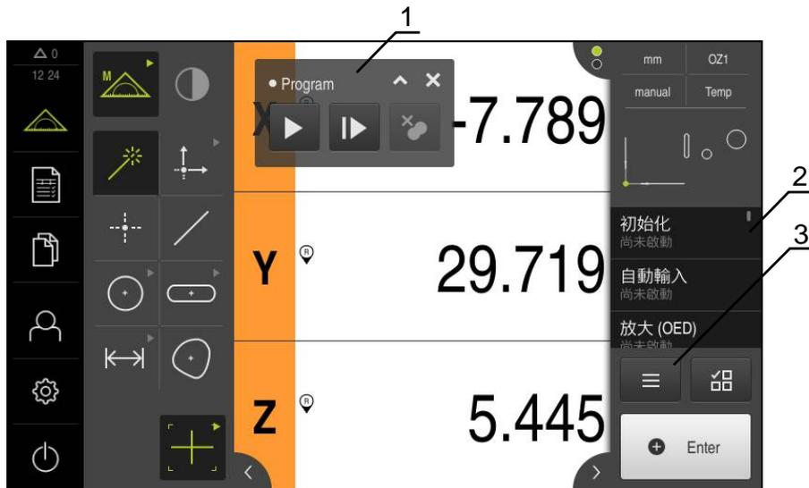
圖形 81: 量測程式的顯示與控制
