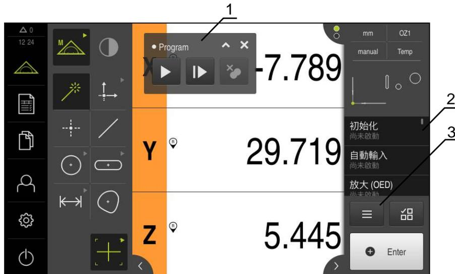
圖形 29: 量測程式的顯示與控制
