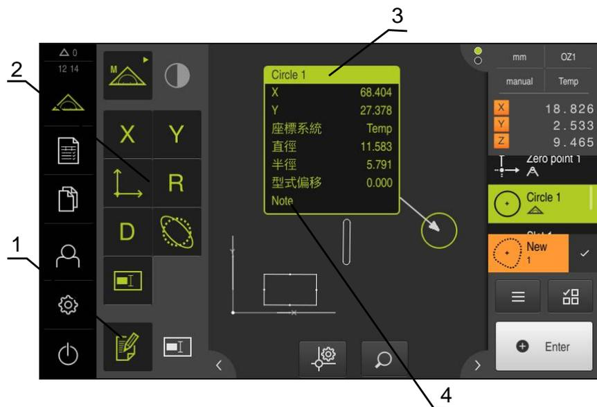
圖形 75: 注釋的操作元件以及含注釋的部件
