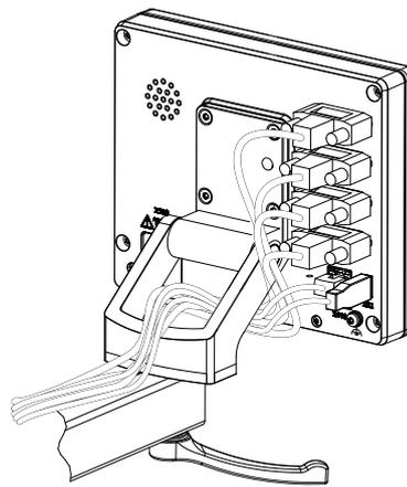
圖形 7: 多位置固定架上的纜線佈線
