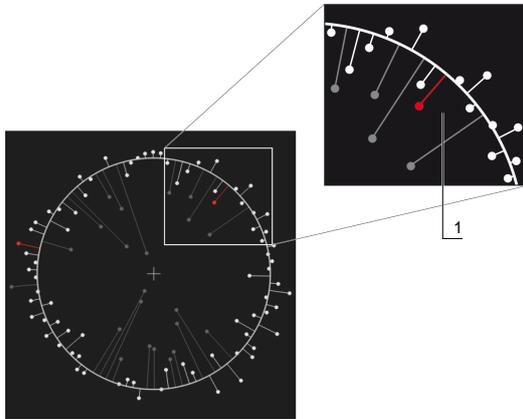
圖形 91: 含點雲與偏差的類型之圖解圖
