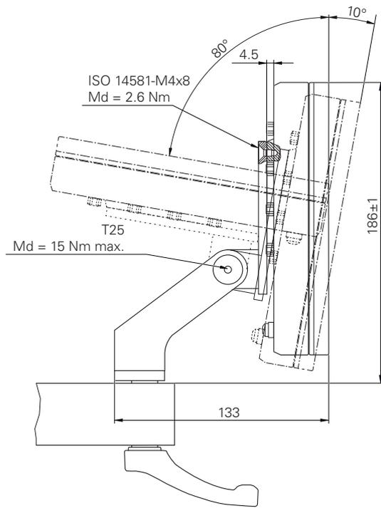
圖形 97: 含多位置固定架的產品尺寸
