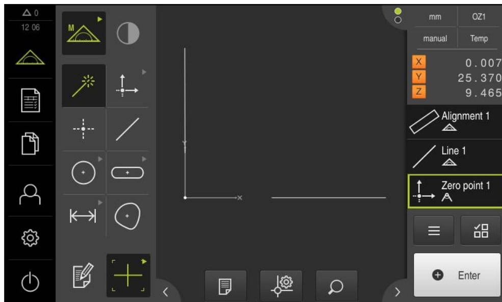
圖形 42: 具備座標系統內所顯示原點的工作空間
