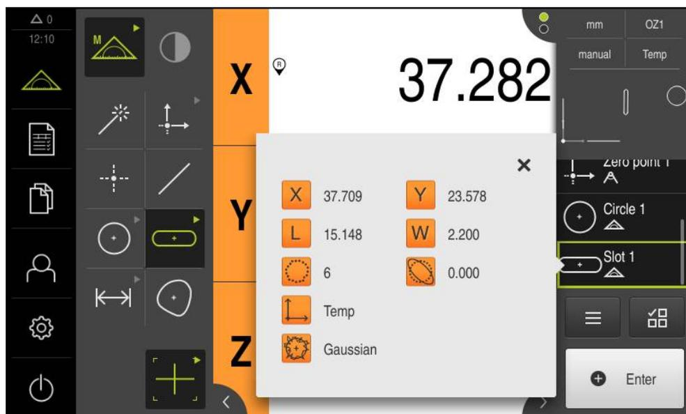
圖形 45: 部件清單內的溝槽部件，含量測結果預覽
