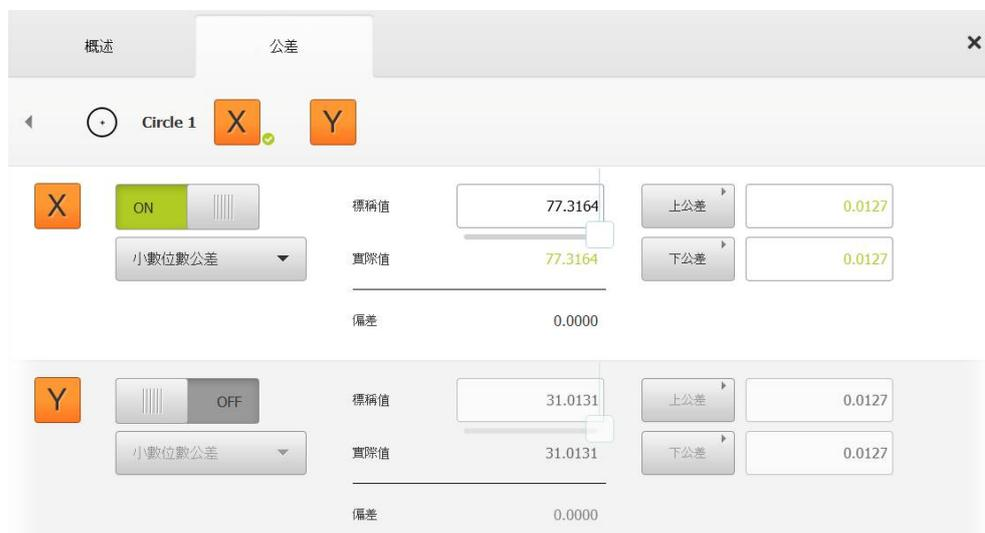
圖形 71: 含X專用已啟動ISO 2768公差的尺寸誤差概述
