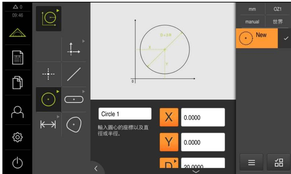
圖形 18: 圓外型的定義功能之操作元件
