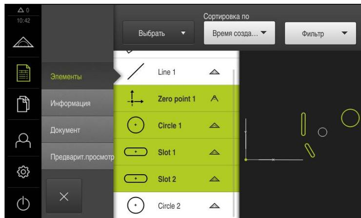
Рисунок 27: Меню **Протокол измерения** со списком элементов и видом по элементам
