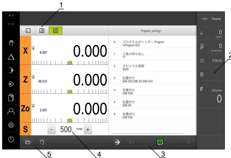
図 21: 使用方法「旋削」の「プログラムラン」メニュー
