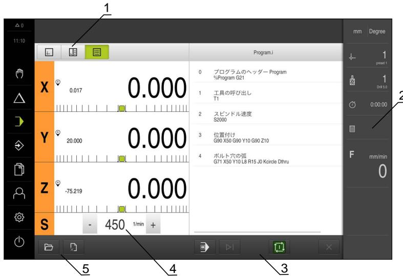
図 20: 使用方法「ミリング加工」の「プログラムラン」メニュー
