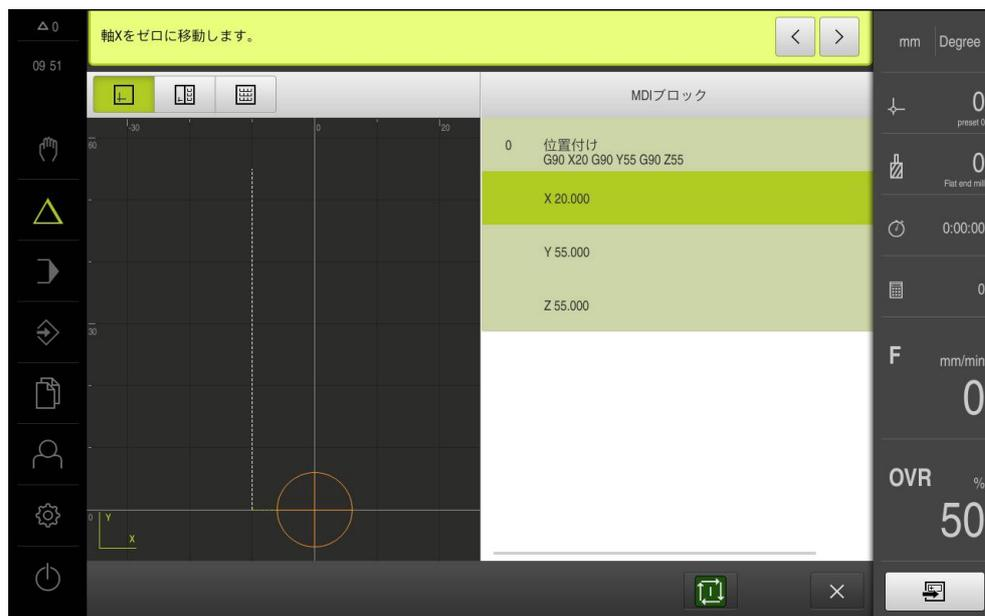
図 63: 例– スケーリングを使った MDI ブロックの実行
