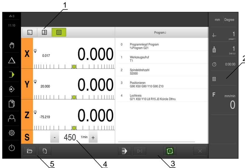
Abbildung 20: Menü **Programmlauf** in der Anwendung Fräsen
