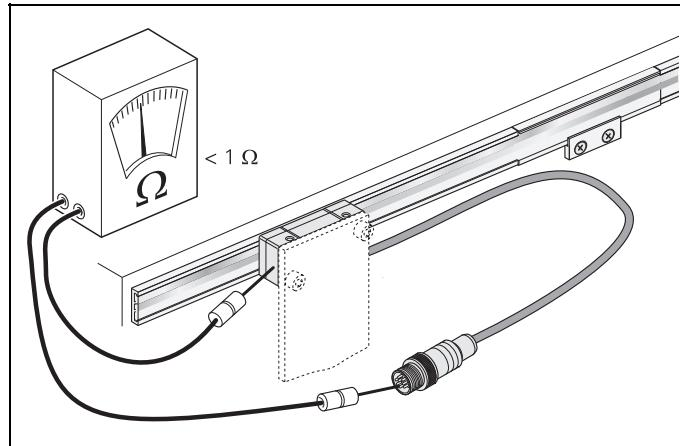
Tester la résistance électrique entre le carter de la prise et la machine.
