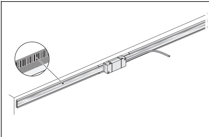
Maßband in Maßbandträger einschieben (nicht knicken). Anschließend Maßband mit Spannpratze **Z** fixieren.
