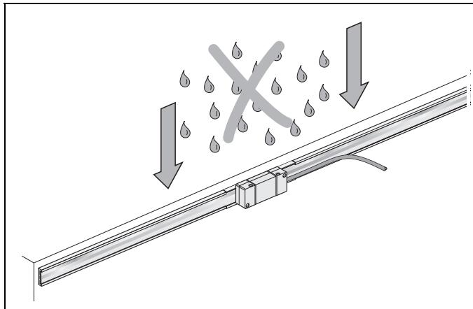
Choisir l'implantation de manière à ce que le déplacement max. soit compris dans la longueur de mesure ML du ruban de mesure. Ⓐ = Début longueur utile ML
