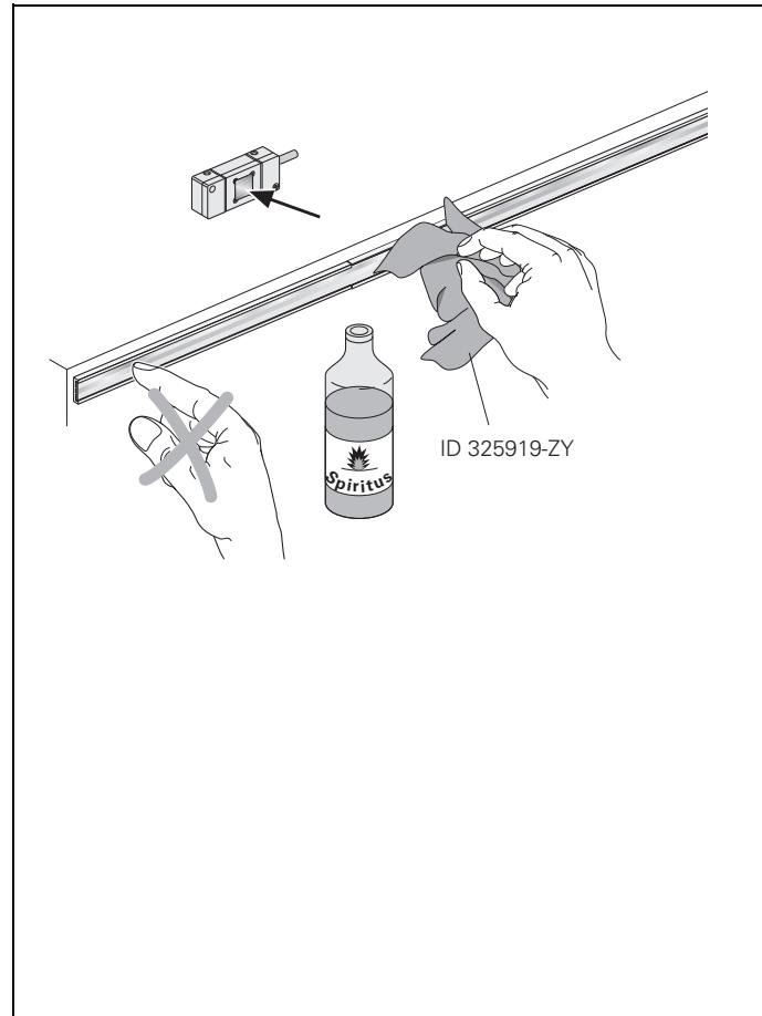
**Si nécessarie:** Nettoyer la gravure de la règle et de la tête caprice à l'aide d'un tissu non pelucheux et d'alcool ou d'isopropanol.
